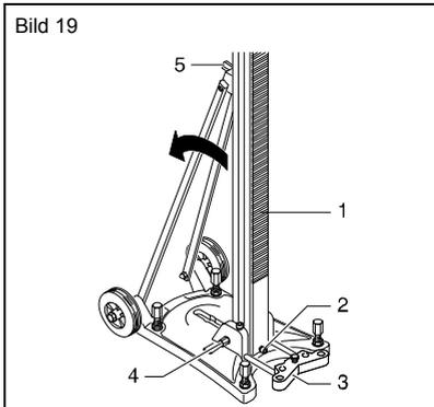
Der Bohrständer kann bis 45° Neigung stufenlos verstellt werden.
